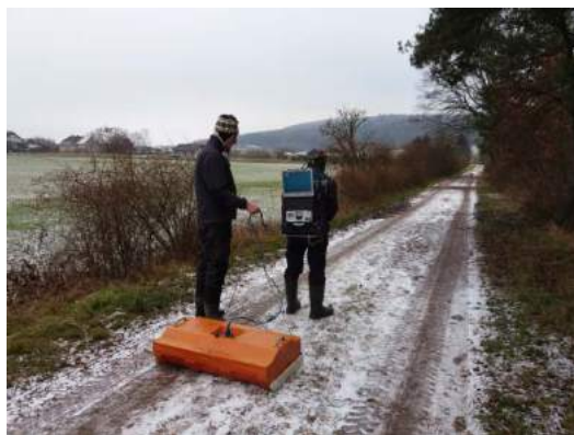
Obr. 5ab Měření georadarovou metodou na lokalitě Žireč
